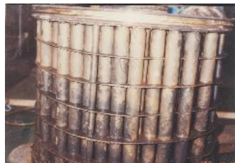
一般水処理剤使用時の状態 温度が上昇すると多量の Scaleが付着する。
